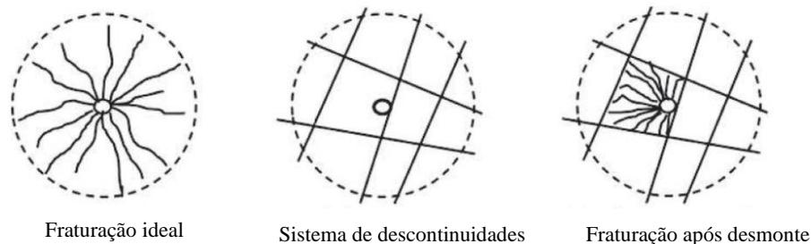
Figura 7 - Efeito das estruturas na fragmentação (Fonte: Adaptado de Hustrulid, 1999).
