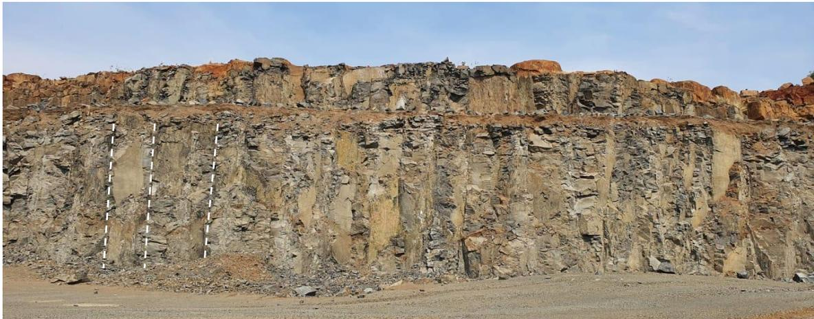
Figura 39 - Face da bancada da Pedreira Mogiana mostrando o maciço bastante alterado e fraturado (Fonte: Adaptado pelo autor).
