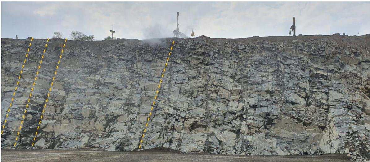
Figura 40 - Face da bancada da Pedreira Nogueirense mostrando o maciço bastante fraturado (Fonte: Adaptado pelo autor).
